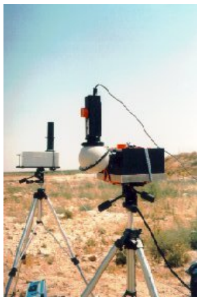
Figura 14. Espectrorradiómetro Optronic754. Rango espectral 250-800. Aperturas: 0.5°, 1.0° y 1.5°. Universidad de Valencia, Grupo Radiación Solar.
