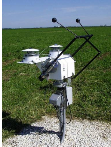
Figura 11. Seguidor solar 2AP. En la plataforma se disponen un pirgeómetro Epply sombreado y ventilado (izquierda) para la medida de la radiación infrarroja entrante. A la derecha se encuentra un piranómetro sombreado y ventilado para la medida de la radiación difusa. En los discos laterales se encuentra el sensor de cuatro cuadrantes y un pirheliómetro Eppley NIP para la medida de la radiación directa. El sensor de cuatro cuadrantes es utilizado por el seguidor solar para mantener la alineación con el Sol.
