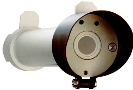
Figura 5. CH-1 NIP (Normal Incidence Pyrheliometer) está diseñado para realizar medidas automáticas de la radiación solar directa, de 0.2 a 4.0 \mu\text{m} . Está diseñado para su utilización con cualquier modelo de seguidor solar Nesa. Tiene la opción de acoplar una rueda de filtros manual para modificar la entrada estándar de 200 nm, a 530, 630, o 695 nm.
